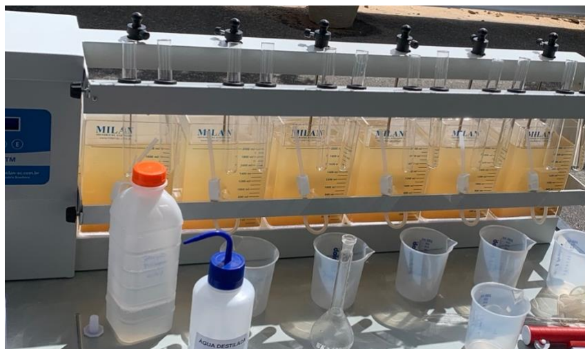
Figura 4: Jar Test fornecido em colaboração com a concessionária de água Rio + Saneamento. Fonte: acervo do autor. Fonte: acervo do autor.
