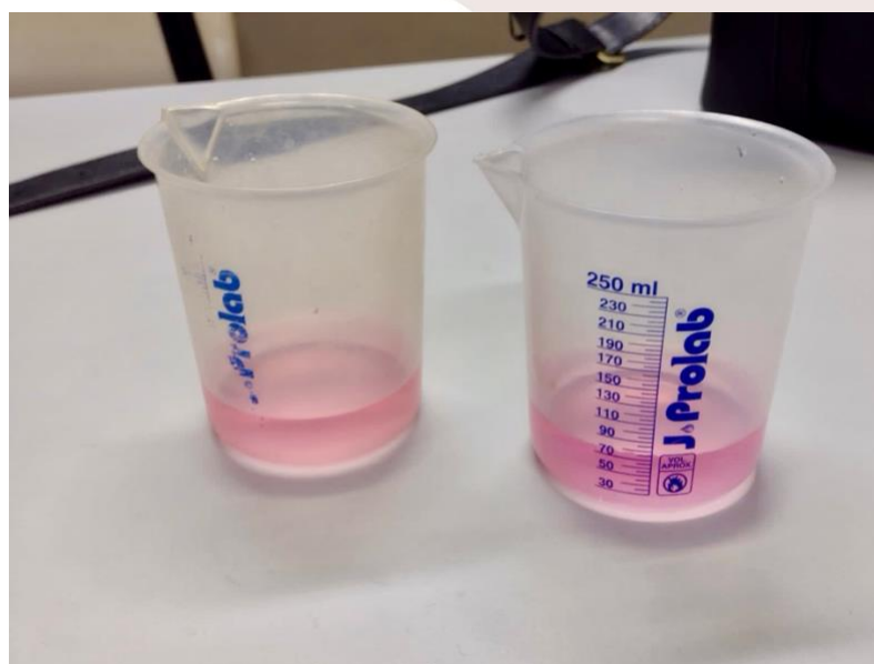
Figura 5 Análise da concentração de cloro livre. acervo do autor. Fonte: acervo do autor.
