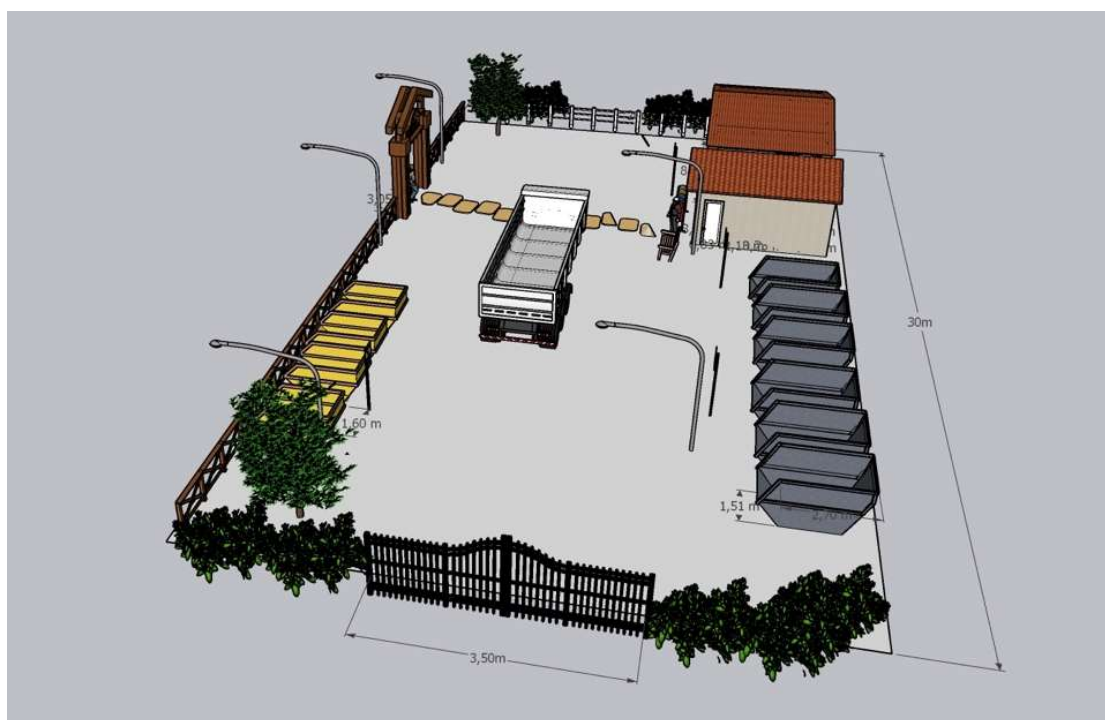
Figura 5 – Área destinada a chegada (portão) de caminhões e área de manobra de veículos.
