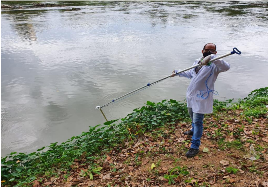
Figura 16 – Teste de campo com a sonda multiparamétrica.
