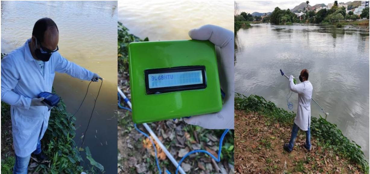
Figura 18 – Teste com a sonda no Rio Paraíba do Sul.
