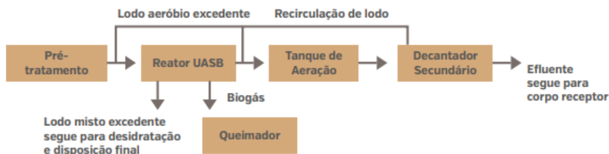
Figura 4 -Arranjo de UASB
